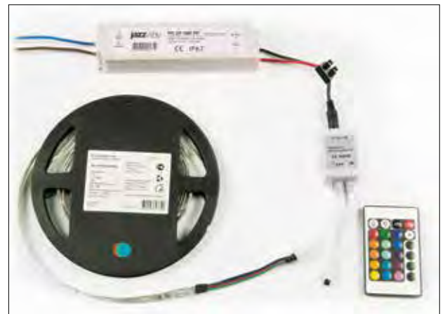
Пример подключения светодиодной ленты с контроллером RGB ZC-1000RC
